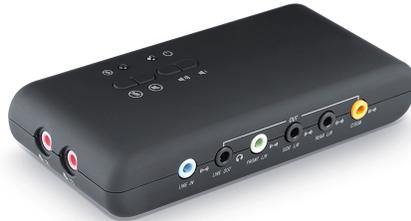
Figura 7.2.6: Tarjeta de sonido 7.1 del fabricante CSL
